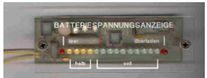
Anzeige zum Einbau ins Armaturenbrett Maße ca. 90x30x20 mm
